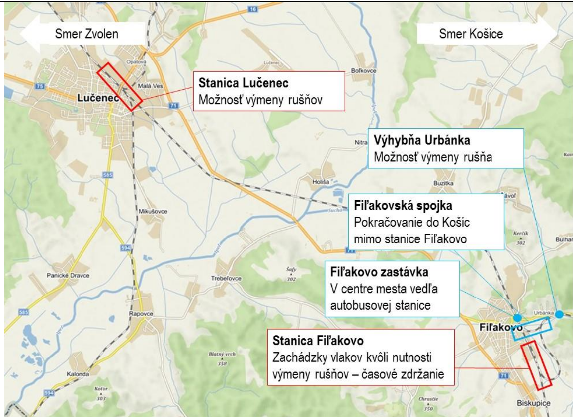
Obrázok 2: Možnosti ukončenia elektrifikácie na trati Zvolen - Košice
